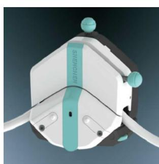
4. 顺时针扳动扳杆180°，使压块下压到位，压紧软管。
