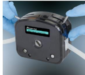
3. 放入压块总成,扳动左右扳杆将压块总成锁死。
