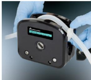
2. 将装好软管的接头或管卡压入泵壳两端的卡槽内。
